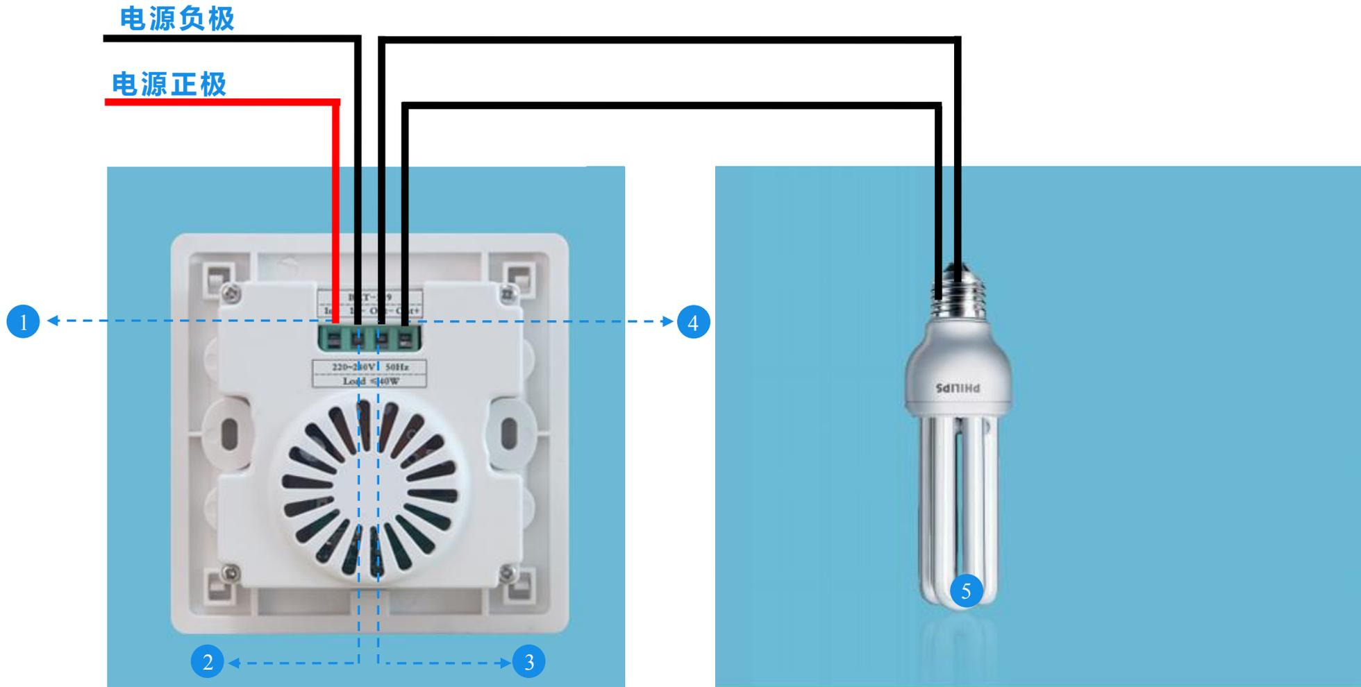
标注：① In+：电源正极接口    ② In-：电源负极接口    ③ Out-：负载接口    ④ Out+：负载接口    ⑤ 负载
