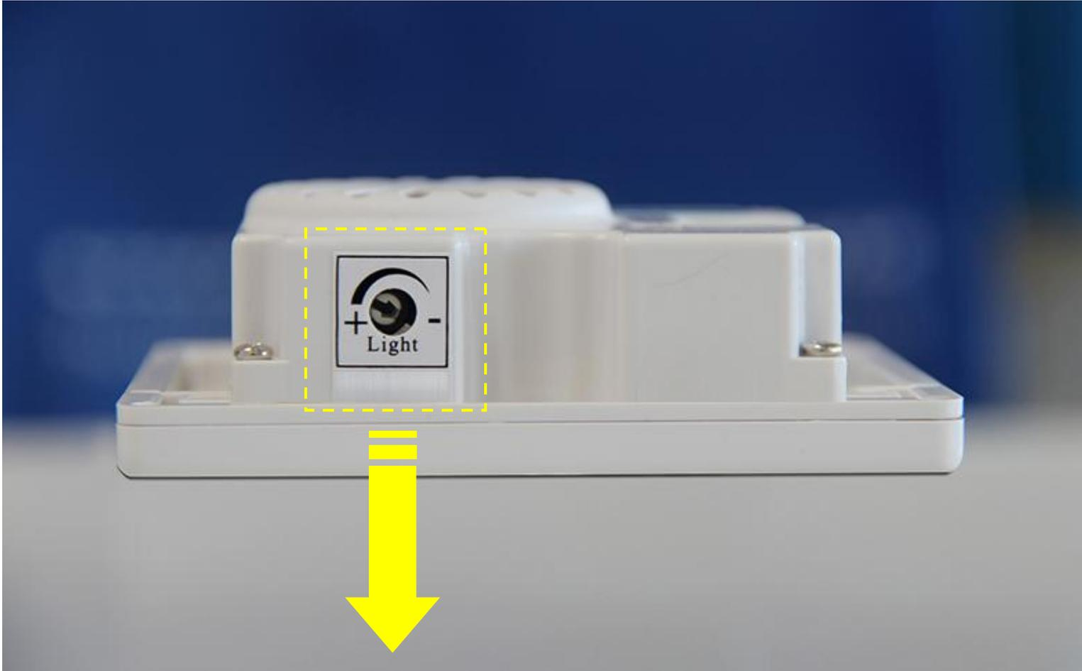
“Light”光感值调节旋钮：光感值用户可在 5-500LUX 范围内自行调节。人在感应范围内活动，当光线低于用户预先设定的光亮度值时，开关方可感应开启，当光亮度高于预设值时，开关不工作。节电能力更强，更精确
