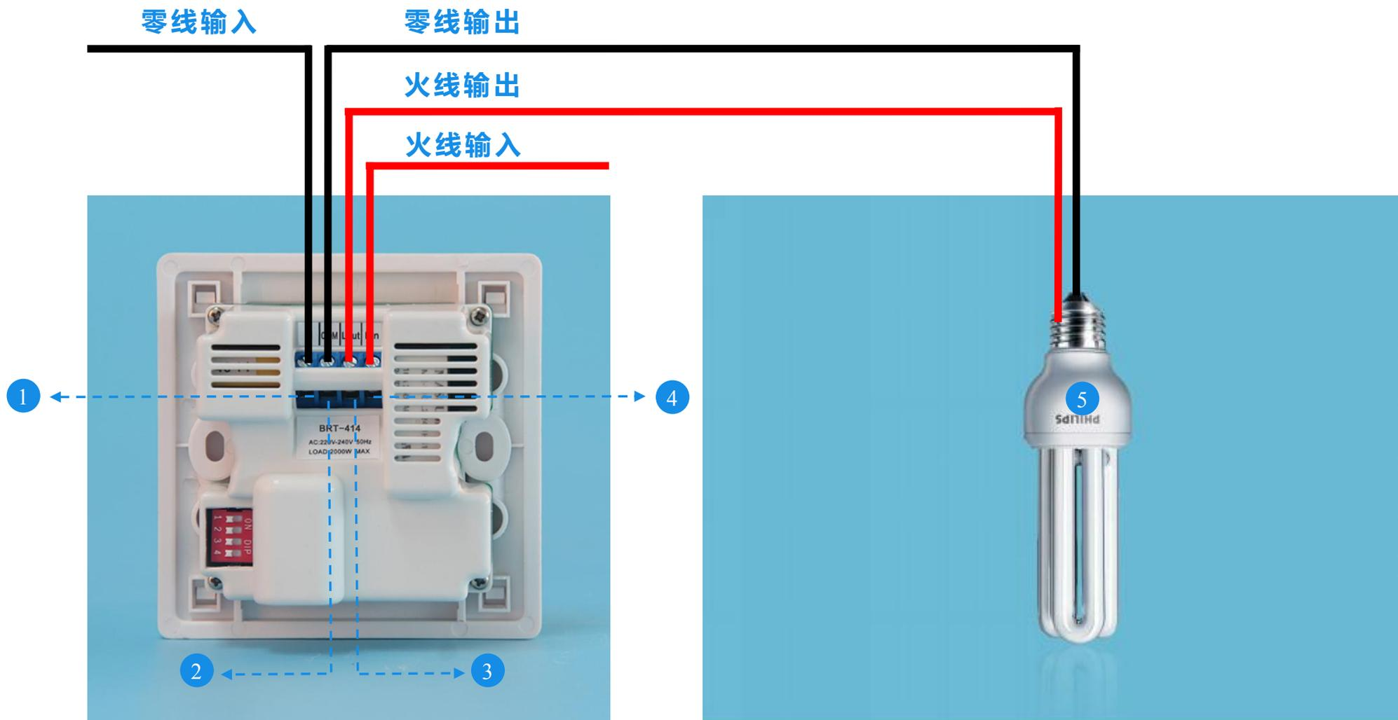
标注：① N：零线输入接口 ② COM：零线输出接口 ③ Lout：火线输出接口 ④ Lin：火线输入接口 ⑤ 负载
