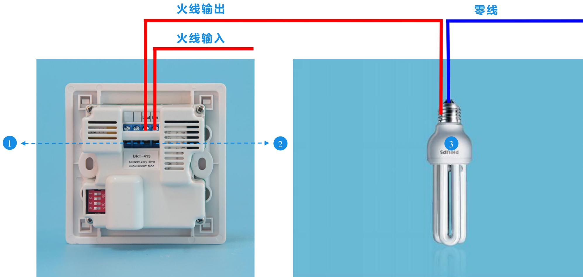
标注：① Lin：火线输入接口    ② Lout：火线输出接口    ③ 负载（灯具）
