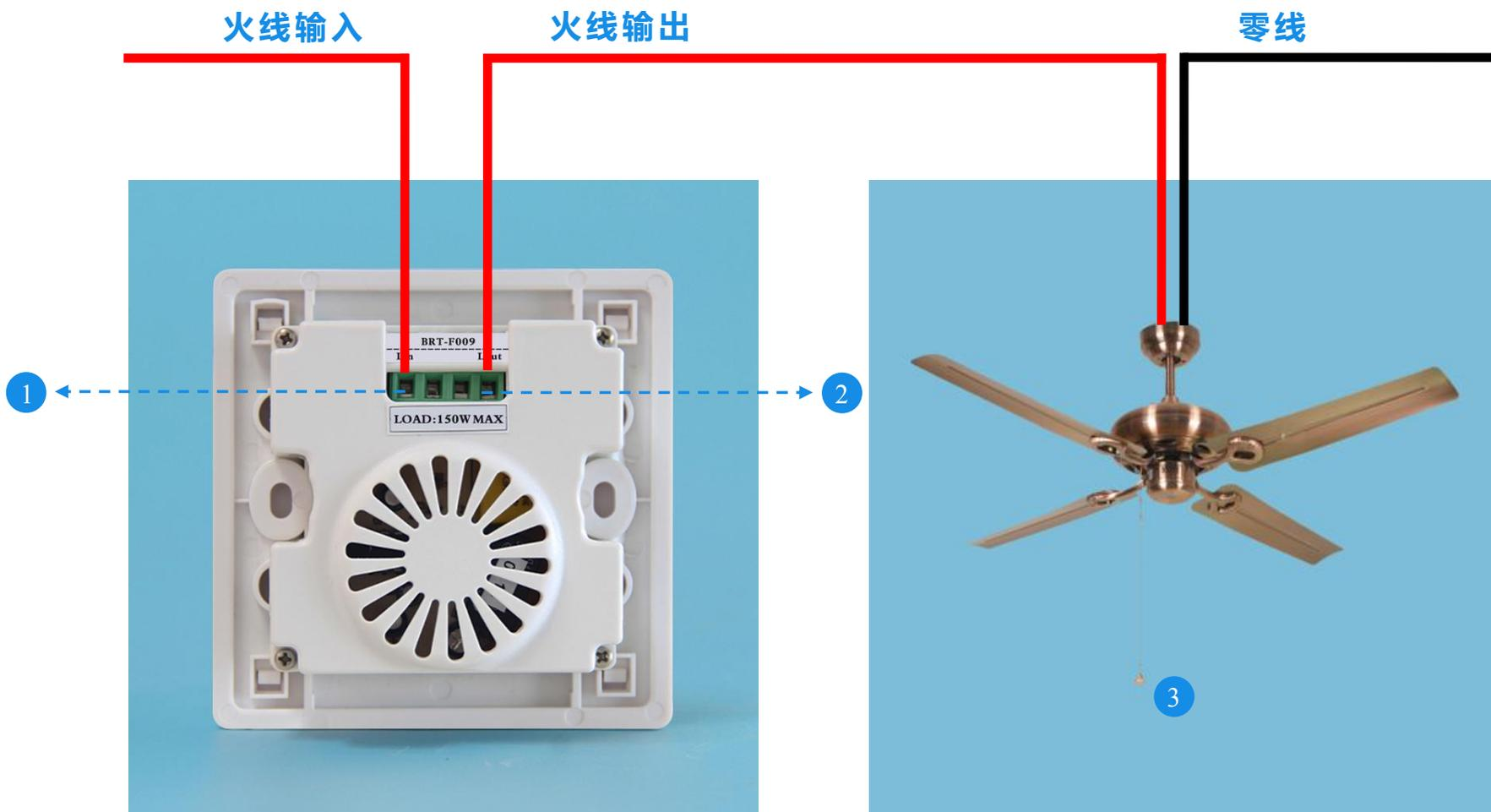
标注：① Lin：火线输入接口    ② Lout：火线输出接口    ③ 负载
