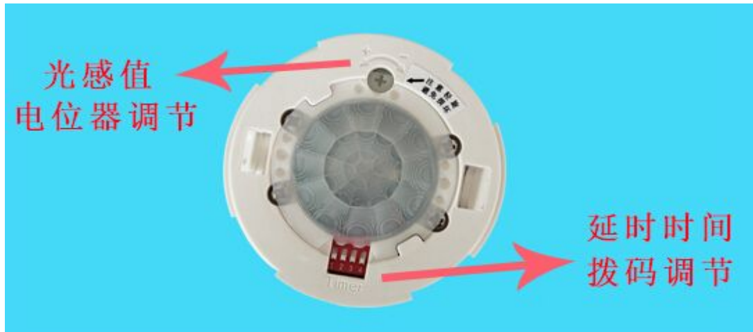
图七 延时时间和光线感应值的调节
