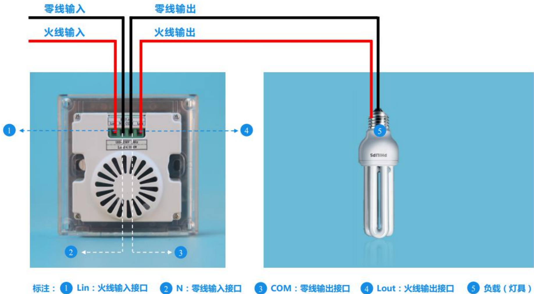
BRT-108 接线示意图
