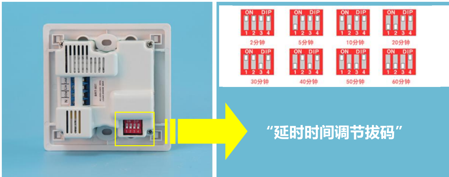
图六 BRT-800/801 开关延时时间调节示意图
