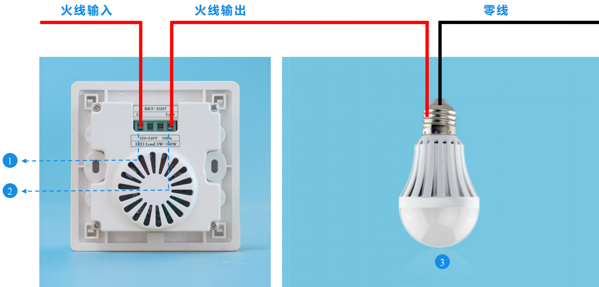
标注：① Lin：火线输入接口 ② Lout：火线输出接口 ③ 负载（LED 灯泡）
