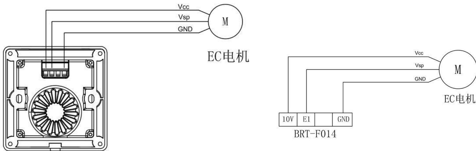
图六 BRT- F014 接线图示
